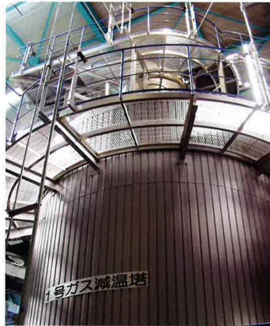
ガス減温塔 排ガスを急冷し、ダイオキシン類の再合成を抑制します
