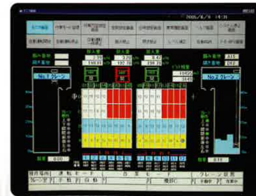
ごみクレーン監視CRT画面(ごみクレーン自動制御盤)
