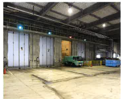
プラットフォーム 計量を終えた収集車がプラットフォームへ進入し、投入扉を開いてごみピットへ投入します。
