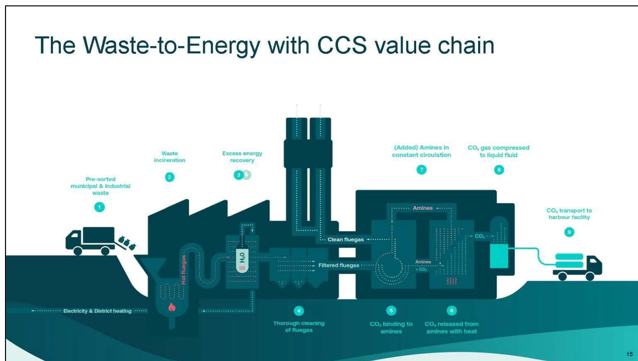
図 3 CO 2 回収設備概要
