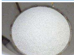
蓄熱材充填状況
