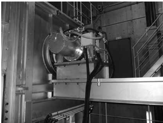
図1 スターリングエンジン廃熱発電システム (発電出力 5kW)
