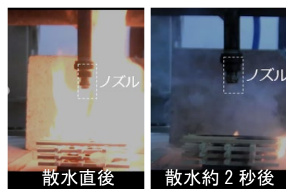
図 3 実験写真 (45 秒間燃焼の消火状況 (4 L/min・m 2 ))
