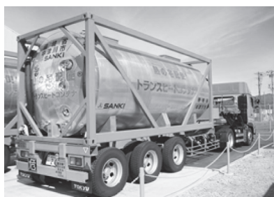
図 2 大容量型トランスヒートコンテナの輸送形態の一例
