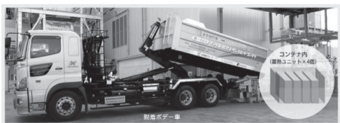
図 3 標準容量型トランスヒートコンテナの輸送形態の一例
