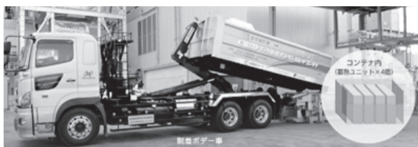
図3 標準容量型トランスヒートコンテナの輸送形態の一例
