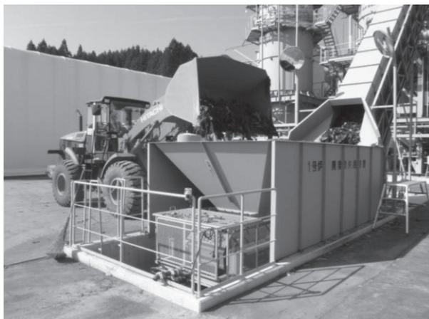
写真2 運転状況（混合廃棄物の投入）
