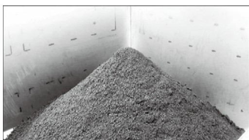
図3 SDRインパクト脱水汚泥の外観 (混合生汚泥 含水率68%以下)
